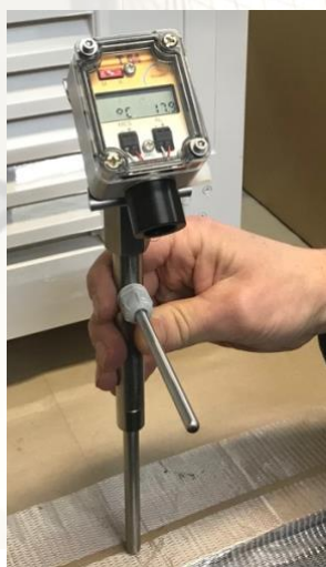
THN-07 montage température sol.
