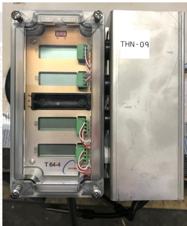
THN-09 – 4 voies pour mesures profondeurs 10/-20/-50/-100cm
