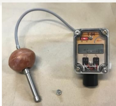
THN-08 montage température Bac
